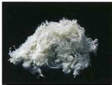
白石綿(クリソタイル)
