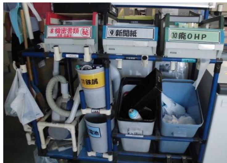
▲パイプの骨組みと箱を使用し、多品目を省スペースに設置
